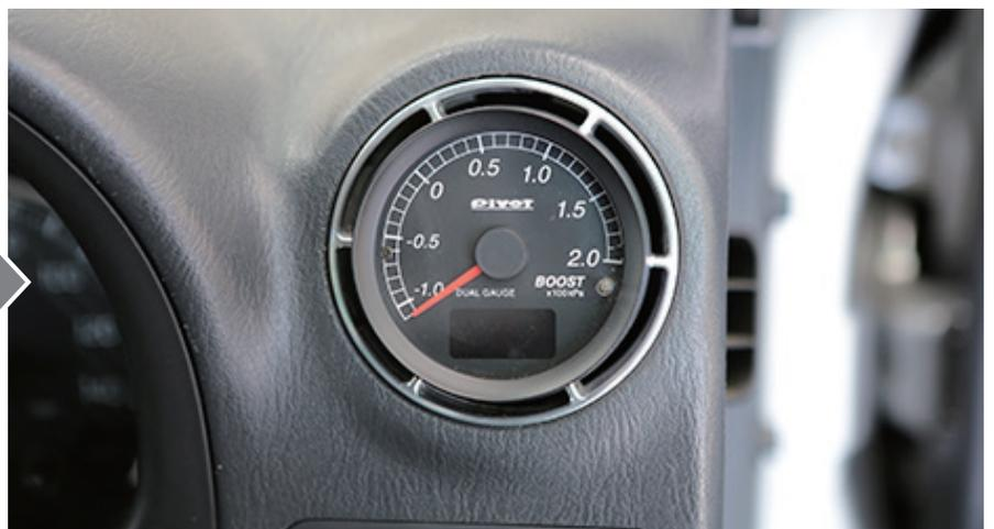
リングをダクトに差し込み、配線を接続してメーターを差し込みます。メーターにはメーター付属のスポンジパッドを貼って下さい。パッドが無く、メーターが緩い場合はホームセンターなどで隙間テープなどをご用意下さい。
