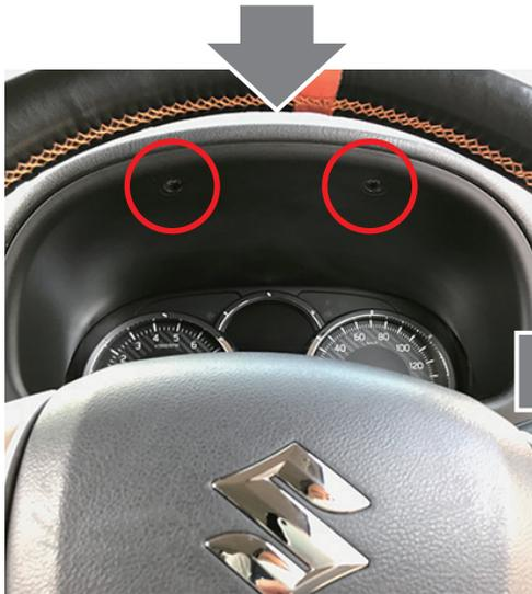
メーターフード内の2カ所のボルトをプラスドライバーで外し、フードパネルを引き抜きます。
