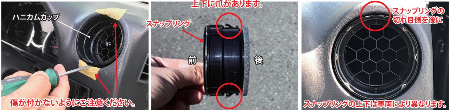
運転席側ルーバーを手前に引っ張り抜きます。ルーバーを外すとハニカムのカップがダクトに差し込まれているので、これをを外します。ハニカムカップは上下の爪でしっかりとダクトにはまっていますのでマイナスドライバーなどで少し潰すように爪を下げて外します。上下2つの爪は金属スナップリングの切れ目のある方を後に外す様にして下さい。スナップリング上下の向きは車両によって異なります。マイナスドライバーなどで抉る場合はインパネに傷つかないようにテープなどで保護して下さい。
