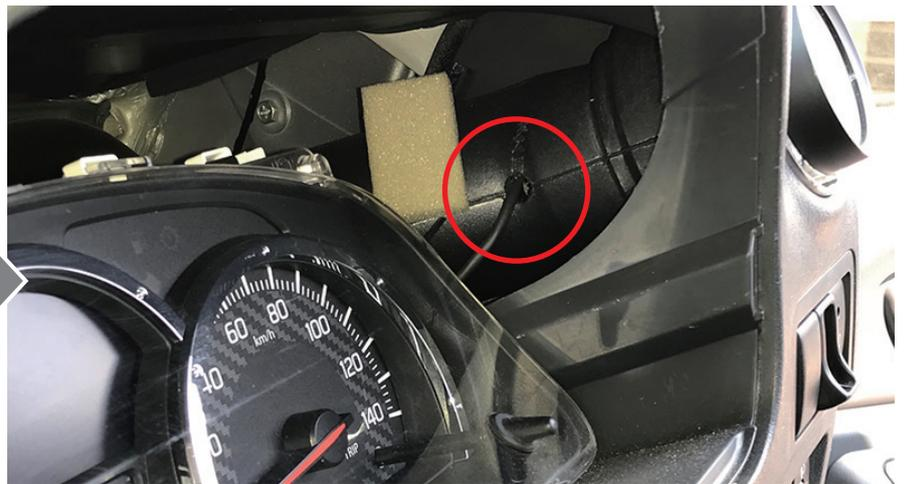
メーターフードパネルを外すとエアコンダクトが見えるので配線が出しやすい適当な位置にカプラーが入る程度の穴をドリルで空け配線を通します。Pivot DXBの場合は10mmの穴でカプラーが通ります。
