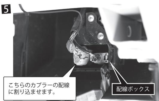
配線ボックスの蓋を開け、写真のカプラーの配線にエレクトラタップで割り込ませます。
