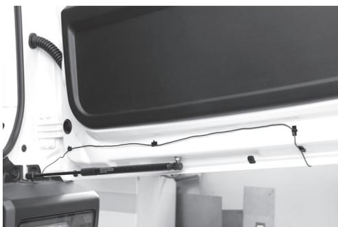
内側に回した配線はゲートに沿ってゲートの付け根に持って行きます。配線止めを必要に応じて使用して下さい。
