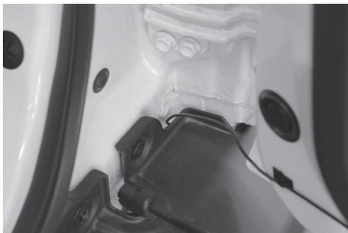
配線はバンパー右側から差し込み車両下側へ出します。この状態でリアゲートを開閉して配線が突っ張らないか確認して下さい。
