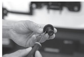
外したゴムにキリで1箇所穴を空け、ナンバー灯の配線を通します。
