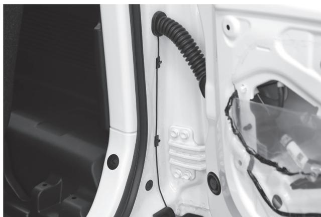
蛇カバーの付け根から配線を取り出し、取付Aと同様にバンパー右側から配線を車両下側へ落とします。配線止めを必要に応じて使用して下さい。
