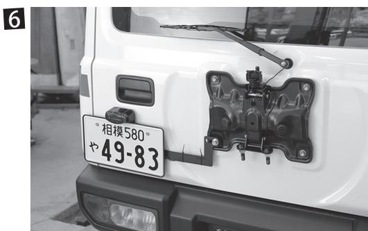
ナンバープレートベース、ナンバープレートを取り付けます。取り付けの際に、移動プレート本体と台座の間にナンバー灯のアース線を挟む様にして下さい。取り付け後ナンバー灯の点灯を確認して下さい。
