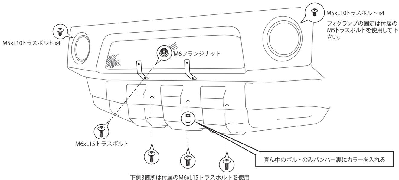
**5** 各種配線、ホース類を接続し、ナンバープレートを取り付けて作業完了です。装着後にはランプ類、ウォッシャーの動作確認を行って下さい。
