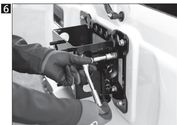
6 ベースプレートとサイドプレートを仮止めしている4箇所のナットを増し締めします。
