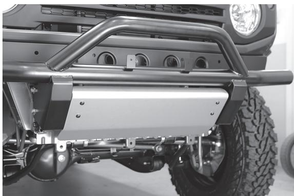
商品付属の M8 x L20 ボタンボルトとM8フランジナットを使用してアルミプレートを固定します。
