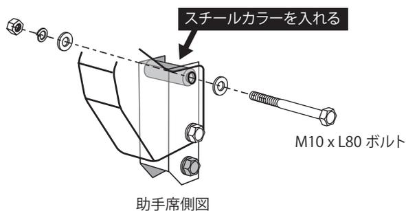
**7** 各ボルトナットを増し締めして下さい。
