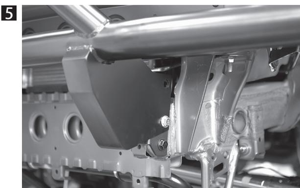
しし狩りバンパーをブラケットに差し込み、下側のボルトからバンパーを仮止めします。
