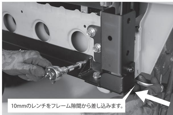
各ブラケットが組めたらブラケット類のボルトナットを増し締めしてしっかりと固定して下さい。ナット抑える工具は上記写真の様にフレーム穴、隙間から差し込みます。
