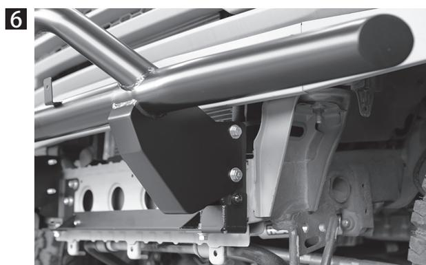
しし狩りバンパーをブラケットに差し込み、M10 x L80ボルトで固定します。
