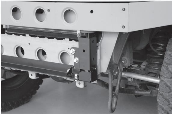
バンパーブラケット、ロアブラケットよりコーナーブラケットが外側になる様にしてコーナーブラケットを仮止めします。
