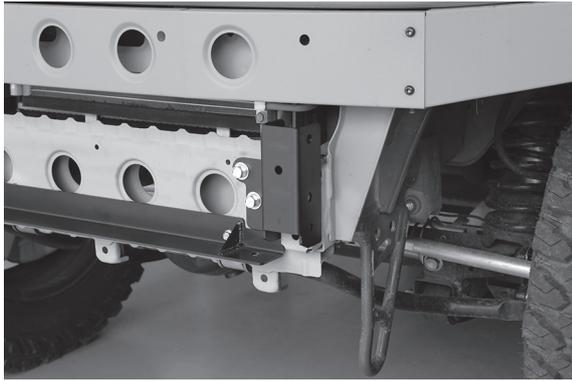
バンパーブラケットとロアブラケットを車体フレームに仮止めします。それぞれナットはフレームのバーリング穴から裏に入れて下さい。
