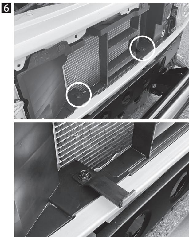
写真の2箇所のクリップを外して、付属の振れ止めステーを取り付けます。
