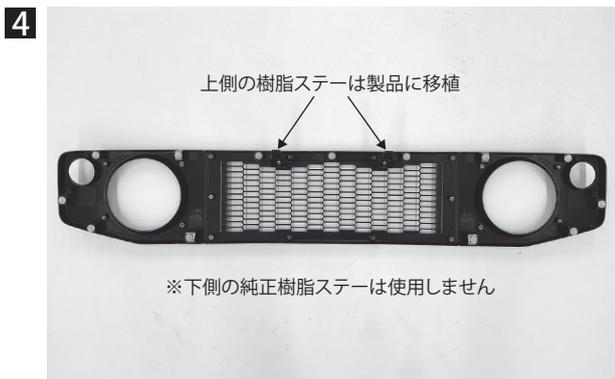
弊社製品に純正グリルからウィンカーユニット、差込リテナー、上2箇所樹脂ステーを移植します。
